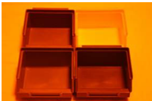
Foto: Oranje Sox licht, alles lijkt rood/oranje Foto: wit licht, alle kleuren zichtbaar
